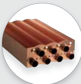
Scambiatore integrato a 2 ragni, 7 passaggi con ampie sezioni (Ø 22 mm) SOLO SERIE SLIMBOX
