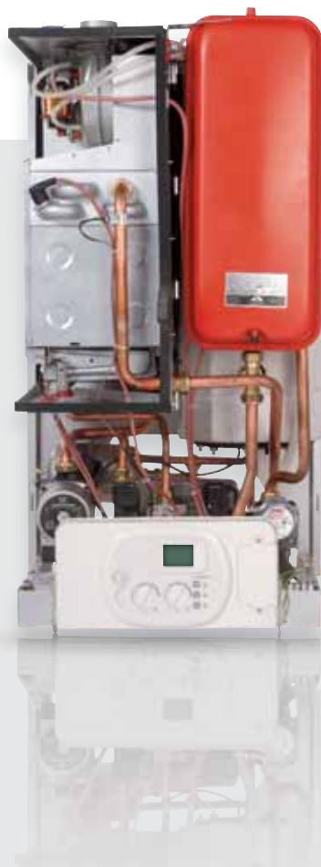
Scambiatore integrato a 2 ragni, 7 passaggi con ampie sezioni (Ø 22 mm)
